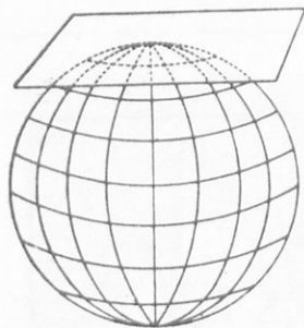
Σχ. 48. Όριζοντία προβολή ή ὀρθογραφική προβολή. Τὸ ἐπίπεδον ἐφάπτεται τῆς ὑδρογείου σφαίρας εἰς τὸν Βόρειον Πόλον. Οἱ παράλληλοι κύκλοι προβάλλονται ὡς συγκεντρικοί κύκλοι καὶ οἱ μεσημβρινοὶ ὡς εὐθεῖαι ἀναχωροῦσαι ἀκτινοειδῶς ἀπὸ τὸν πόλον.
