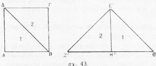
Τὰ ἐπίπεδα σχήματα  $\text{ABΓΔ}$  καὶ  $\text{E'Z'Θ'}$  (σχ. 43) ἔχουν ισοδυνάμους ἐπιφανείας. Τοῦτο δυνάμεθα νὰ διαπιστώσωμεν διὰ καταλήλου διαιρέσεως αὐτῶν. Τὰ ἀνωτέρω σχήματα λέγονται ισοδύναμα σχήματα.
