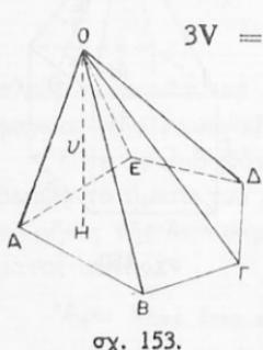
3. Διά νά μετρήσωμεν τυχοῦσαν πυραμίδα ΟΑΒΓΔΕ (σχ. 153), ή όποια έχει έμβαδὸν βάσεως  $E_B$  καὶ ύψος  $v$  διαιρούμεν αὐτὴν είς τὰς τριγωνικὰς πυραμίδας ΟΑΒΓ, ΟΑΓΔ, ΟΑΔΕ, αἱ όποιαι έχουν τό αὐτὸν ύψος καὶ σγκους ἀντιστοίχως  $V_1$ ,  $V_2$ ,  $V_3$ , έμβαδὰ δὲ βάσεων τὰ  $E_1$ ,  $E_2$ ,  $E_3$ , έχοντα ἄθροισμα  $E$ . Οθεν :
