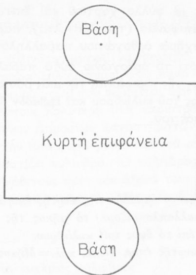
Σχ. 22. Ἀνάπτυγμα ὀλικῆς ἐπιφάνειας κυλίνδρου
