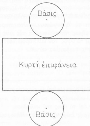
Σχ. 22. Ἀνάπτυγμα ὀλικῆς ἐπιφάνειας κυλίνδρου
