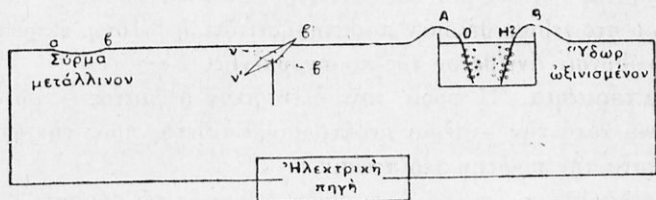
Σχ. 152. Γνωρίσματα ἡλεκτρικοῦ ρεύματος.
