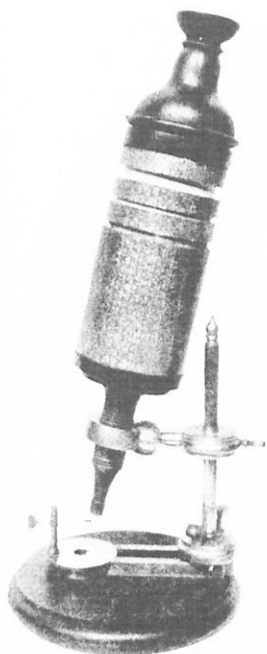
Εικόνα 8: Τό σύνθετο μικροσκόπιο του Hooke.
