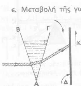
Σχ. 149. Μεταβολή της γωνίας έκτροπής με τη διαθλαστική γωνία του πρίσματος
