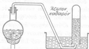
Σχ. 35. Παρασκευή καθαρῷ ἄζωτου.
