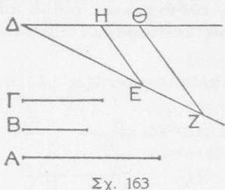
Κατασκευάζομεν γωνίαν  $\Delta$  καὶ εἰς τὴν μίαν πλευράν δρίζομεν τμήματα  $\Delta E$  καὶ  $EZ$  ἀντιστοίχως ἵσα πρὸς τὰ  $A$  καὶ  $B$ . Εἰς δὲ τὴν ἄλλην πλευράν δρίζομεν τμῆμα  $\Delta H$  ἵσον πρὸς τὸ  $\Gamma$ . Φέρομεν ἔπειτα τὴν  $EH$  καὶ τὴν  $Z\Theta$  παράλληλον πρὸς αὐτὴν.
