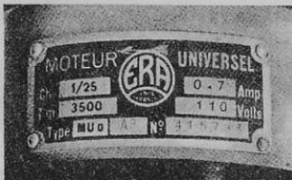
Σχ. 213, β. Έπιγραφὴ μὲ τὰ χαρακτηριστικὰ στοιχεῖα ένδος ηλεκτροκινητῆρα. (1/25 Ch, 3 500 στρ./min. 0 - 7 Ampere, 110 Volt).
