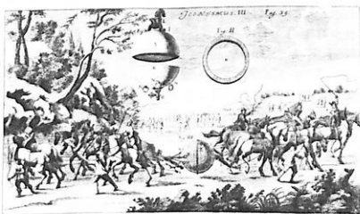
σχ. 247. Τὸ ἱστορικὸ πείραμα τῶν ἡμισφαιρίων, τὸ ὁποῖο ἐξετέλεσε ὁ δῆμαρχος τοῦ Μαγδεμβούργου Otto von Guericke (1654).
