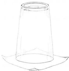
Σχ. 243. Τὸ νερὸ τοῦ ἀναποδογυρισμένου ποτηριοῦ δὲν χύνεται, χάρις στὸ χαρτί πὺν ἐφάπτεται στὰ χεῖλη τοῦ ποτηριοῦ.
