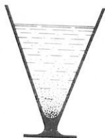
Σχ. 17. Τά στερεά αιώρουμένα σωματίδια καθίζανον στον πυθμένα του δοχείου.
