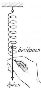
Σχ. 77. Δράση καὶ ἀντίδραση σὲ σπειροειδὲς ἐλατήριο.
