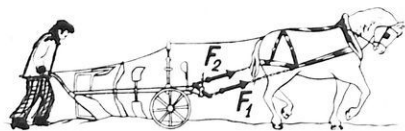
Σχ. 91. Το άλογο ασκεί με τους ιμάντες δύο παράλληλες και ομόρροπες έλκτικές δυνάμεις στο άροτρο.
