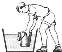
Σχ. 218. Γιὰ νὰ βυθίσουμε τὸν ἀδειανὸ κουβά πρέπει νὰ ἀσκήσουμε μεγάλη δύναμη.
