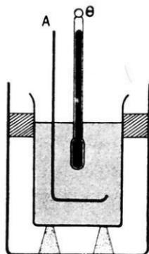
Σχ. 244. Θερμιδομέτρον. (Α ἀναδευτήρ, Θ θερμιδομέτρον).
