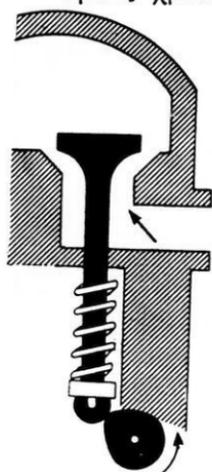
Σχ. 267. Μηχανισμός αὐτομάτου λειτουργίας τῶν βαλβίδων.
