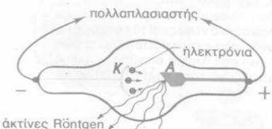
Σχ. 4. Σωλήνας παραγωγής άκτινων Röntgen (έργαστρη πλακός)
