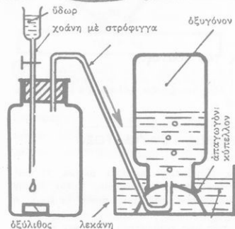
1 ΠΑΡΑΣΚΕΥΗ ΟΞΥΓΟΝΟΥ ΑΝΕΥ ΘΕΡΜΑΝΣΕΩΣ.
