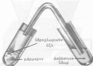
(3) ΤΟ ΣΧΗΜΑΤΙΖΟΜΕΝΟΝ ΑΕΡΙΟΝ ΘΟΛΩΝΕΙ ΤΟ ΑΣΒΕΣΤΙΟΝ ΥΔΩΡ
