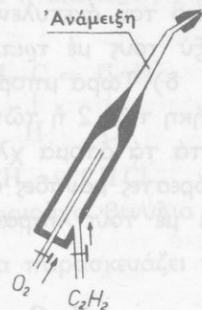
Σχ. 13. Η φλόγα του άκετυλενίου χρησιμοποιείται για τή συγκόλληση μετάλλων.
