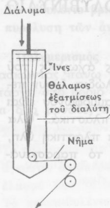
Σχ. 25. Μέ το χλωριούχο πολυβινύλιο κατασκευάζονται νήματα.
