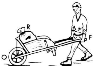
Σχ. 3. Εις ποίαν θέσην πρέπει να τοποθετήσωμεν τον σακκόν, ώστε ή δύναμις, τήν οποίαν θα καταβάλωμεν, να είναι έλαχιστή;
