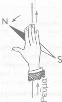
Σχ. 72. Σχέση μεταξύ τής φοράς του ρεύματος και τής έκτροπής τής μαγνητικής βελόνης.
