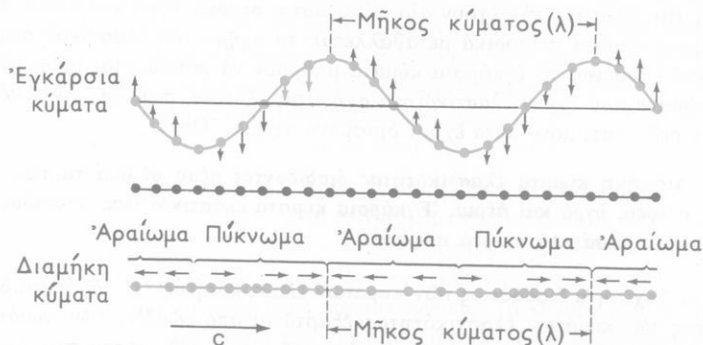
Σχ. 21. Ἡ διάδοση τῶν ἐγκάρσιων καὶ τῶν διαμήκων κυμάτων. Στὰ διαμήκη κύματα σχηματίζονται διαδοχικὰ πυκνώματα καὶ ἀραιώματα. Στὸ μέσο δείχνονται τὰ ὄλικα σημεῖα τοῦ γραμμικοῦ ἐλαστικοῦ μέσου, ὅταν ἰσορροποῦν.
