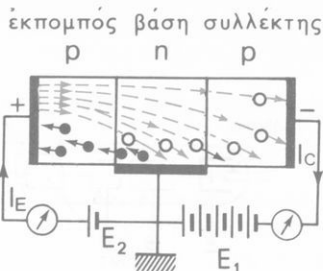
Σχ. 113α. Οι μεταβολές της έντασης του ρεύματος I_E προκαλούν αντίστοιχες μεταβολές στην ένταση του ρεύματος I_C .
