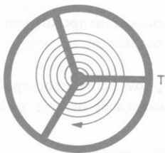
Σχ. 14. Ό αιώτης του ρολογιού εκτελεί στροφική ταλάντωση.
