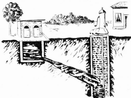
Εἰκ. 77. Φρέαρ, τὸ ὁποῖον μολύνεται ἀπὸ τὸν βόθρον ἀποχωρητηρίου.
