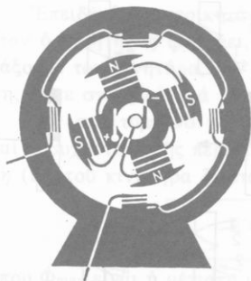
Σχ. 89. Σχηματική παράσταση μονοφασικού έναλλακτήρα. (Ό επαγωγέας έχει 4 πόλους, τó επαγωγίμο έχει 4 πηνία).
