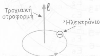
Σχ. 120. Τό περιφερόμενο ηλεκτρόνιο έχει τροχιακή στροφορμή ( l ).
