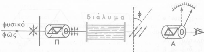
Σχ. 43. Τό διάλυμα προκαλεῖ στροφή τοῦ ἐπιπέδου ταλαντώσεως τοῦ πολωμένου φωτός κατὰ γωνία \varphi .
