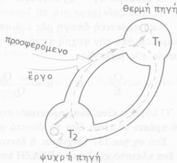
Σχ. 136. Σχηματική παράσταση ψυκτικής μηχανής.
