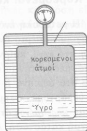
Σχ. 103. Μέτρηση της τάσεως των κορεσμένων ατμών σε κάθε θερμοκρασία.
