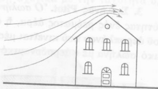
Σχ. 77. Άρπαγή στέγης.
