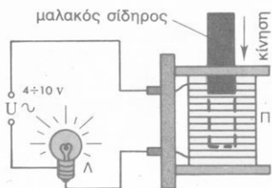
Σχ. 5. Ένας ροοστάτης κατάλληλος μόνο για έναλασσόμενο ρεύμα. ( \Lambda = 3 \div 6 \text{ V} , \Pi = 300 \text{ ή } 600 \text{ σπειρές} )
