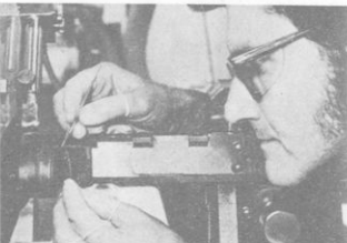
Σχ. 2. Ο κρύσταλλος Si κόβεται μέ διαμάντι σέ λεπτές φέτες καί κατόπιν μέ χημικές μεθόδους εισάγονται στόν κρύσταλλο προσμίξεις άλουμινίου (Al) ή άρσενικού (As)
