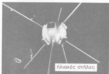
Σχ. 7. Στούς δορυφόρους χρησιμοποιούνται ήλιακές στήλες για να λειτουργούν οι ραδιοπομπές και δέκτες τους
