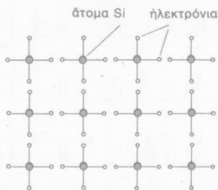
Σχ. 3. Κρυσταλλική δομή καθαρού πυριτίου (Si)
