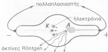
Σχ. 4. Σωλῆνας παραγωγῆς ἀκτίνων Röntgen (ἐργαστηριακός)
