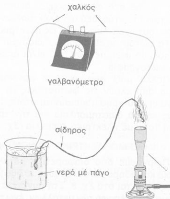
Σχ. 8. Θερμοηλεκτρικό στοιχείο
