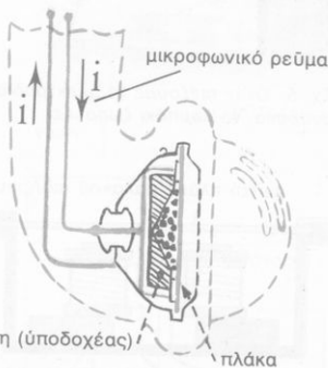
Σχ. 3. Μικρόφωνο μέ κόκκους άνθρακα
