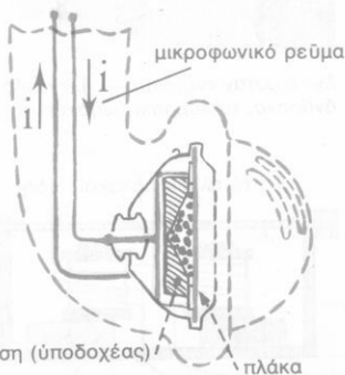
Σχ. 3. Μικρόφωνο μέ κόκκους άνθρακα
