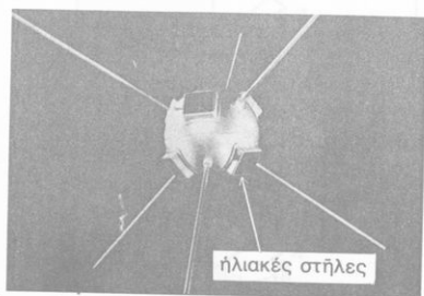
Σχ. 7. Στους δορυφόρους χρησιμοποιούνται ηλιακές στήλες για να λειτουργούν οι ραδιοπομποί και δέκτες τους
