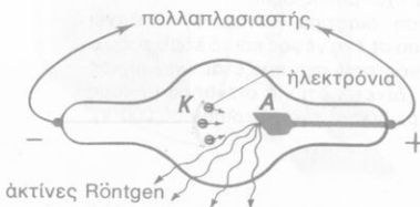
Σχ. 4. Σωλῆνας παραγωγῆς ἀκτίνων Röntgen (ἐργαστηριακός)
