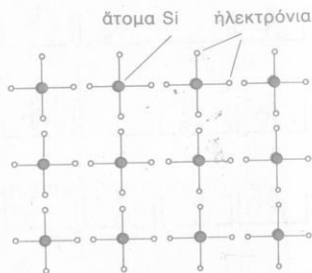
Σχ. 3. Κρυσταλλική δομή καθαροῦ πυριτίου (Si)
