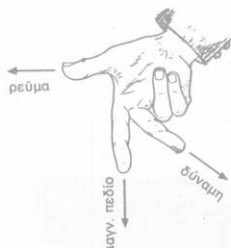
Σχ. 2 Κανόνας του δεξιού χεριού για την εύρεση της φοράς της μαγνητικής δυνάμεως πού ασκείται σέ ρευματοφόρο άγωγό
