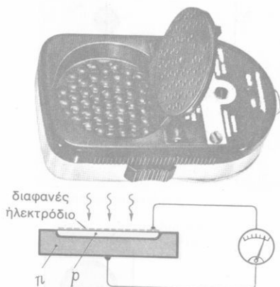
Σχ. 6. Φωτοστοιχείο με κρυσταλλο- δίοδο
