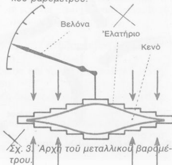
Σχ. 2. Συνήθισμένος τύπος μεταλλικού βαρομέτρου.
