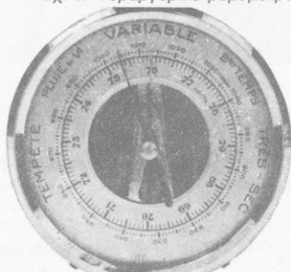
Σχ. 2. Συνήθισμένος τύπος μεταλλικού βαρομέτρου.
