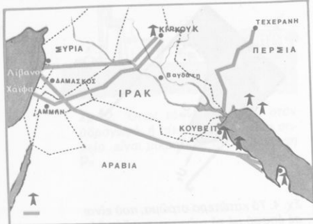
Σχ. 5. Δίκτυο πετρελαιοαγωγών στη Μέση Ανατολή. Ο «διαραβικός» πετρελαιοαγωγός ενώνει τον Περσικό Κόλπο με τη Μεσόγειο Θάλασσα και έχει μήκος 1720 Km
