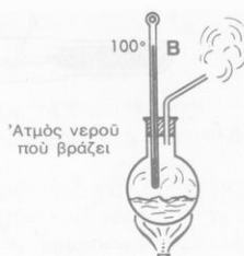
Σχ. 3. Οι άτμοί του νερού που βράζει έχουν πάντοτε τήν ή ίδια θερμοκρασία ( 100^{\circ}\text{C} , όταν Ρατμ. = 760 Torr)
