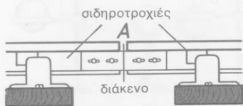
Σχ. 5. (α) Διάκενο μεταξύ των σιδηροτροχιών
