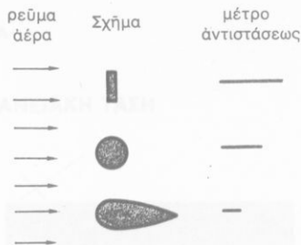
Σχ. 5. Τό άεροδυναμικό σχήμα δέχεται τή μικρότερη αντίσταση
