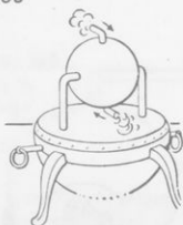
Σχ. 7. «Αἰόλου πύλα» τοῦ Ἡρώνο. Ὁ πρόδρομος τῶν σημερινῶν ἀτμοστροβίλων
