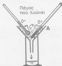
Σχ. 2. Ο πάγος τήκεται πάντοτε στην ίδια θερμοκρασία ( 0^{\circ}\text{C} , όταν Ρατμ. = 760 Τοττ)
