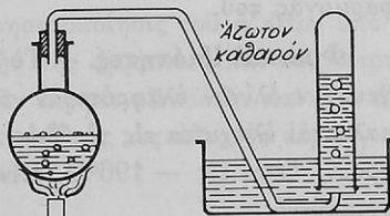
Σχ. 35. Παρασκευή καθαροῦ ἁζώτου
