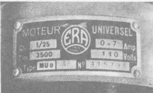
Σχ. 213, β. Ἐπιγραφὴ μὲ τὰ χαρακτηριστικὰ στοιχεῖα ένός ἡλεκτροκινητήρα. (1/25 Ch, 3 500 στρ./min. 0 - 7 Ampere, 110 Volt).
