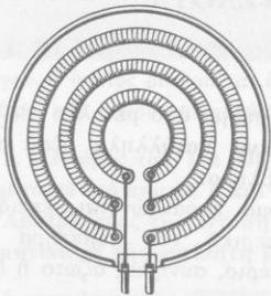
Σχ. 136. Θερμαινόμενη πλάκα μὲ κυκλικὸ ἀγωγὸ σύρμα.
