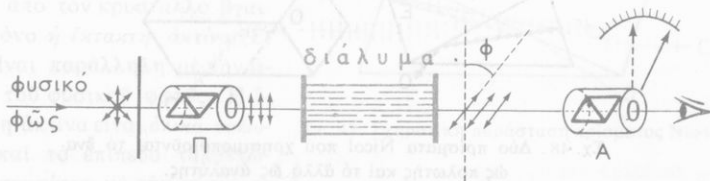
Σχ. 51. Τό διάλυμα προκαλεῖ στροφή τοῦ ἐπιπέδου ταλαντώσεως τοῦ πολωμένου φωτός κατά γωνία \varphi .
