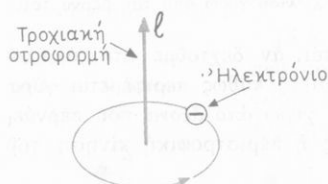
Σχ. 113. Τό περιφερόμενο ηλεκτρόνιο έχει τροχιακή στροφορμή ( l ).
