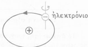
Σχ. 115. Περιστροφή του ήλεκτρονίου γύρω από τόν άξονά του.
