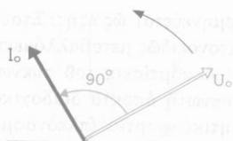
Σχ. 72. Ο δείκτης της εντάσεως ρεύματος προηγείται από το δείκτη της τάσεως κατά γωνία \varphi = 90^\circ .
