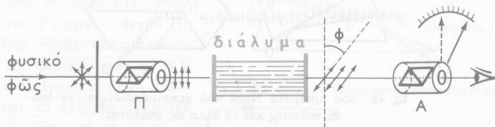
Σχ. 51. Τό διάλυμα προκαλεί στροφή του επιπέδου ταλαντώσεως του πολωμένου φωτός κατά γωνία \phi .
