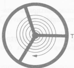
Σχ. 14. Ο αιώτης του ρολογιού εκτελεί στροφική ταλάντωση.
