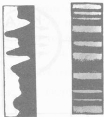
Σχ. 121. Καταγραφή του ήχου πάνω στην κινηματογραφική ταινία (οι ζώνες με τό διαφορετικό μαύρισμα αντίστοιχουν σε ήχους).
