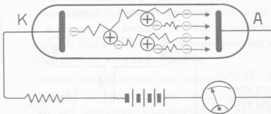
Σχ. 100α. Από τις συγκρούσεις των ηλεκτρονίων με τα άτομα του αερίου προκύπτουν ηλεκτρόνια που κατευθύνονται προς την άνοδο Α και θετικά ιόντα που κατευθύνονται προς την κάθοδο Κ.
