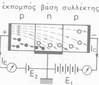
Σχ. 113α. Οι μεταβολές της έντασης του ρεύματος I_E προκαλούν αντίστοιχες μεταβολές στην ένταση του ρεύματος I_C .
