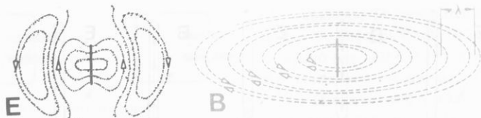
Σχ. 129α. Διάδοση του ηλεκτρομαγνητικού πεδίου στο χώρο 'Αριστερά: Κατακόρυφη τομή του ηλεκτρικού πεδίου Δεξιά: 'Οριζόντια τομή του μαγνητικού πεδίου
