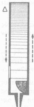
Σχ. 52. Μέσα στο σωλήνα σχηματίζονται διαμήκη κύματα. Στην κλειστή άκρη σχηματίζεται δυσμός.
