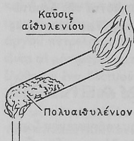
Σχ. 66. Το πολυαιθυλένιον διασπάζεται και παράγεται αιθυλένιον, τὸ ὁποῖον καίεται.
