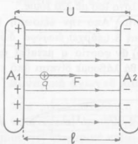
είναι l (σχ. 12). Μεταξύ τῶν δύο πλακῶν σχηματίζεται θμογενές ήλεκτρικό πεδίο, πού έχει σταθερή ένταση. Ε και διαφορά δυναμικοῦ μεταξύ τῶν δύο πλακῶν είναι U. Στή μία άκρη (A<sub>1</sub>) μιᾶς δυναμικῆς γραμμῆς (A<sub>1</sub>A<sub>2</sub>) φέρνουμε ήλεκτρικό φορτίο q. Τότε στό φορτίο αὐτό ένεργει ή δύναμη  $F = E \cdot q$ , ή όποια μετακινεῖ τό φορτίο q κατά διάστημα A<sub>1</sub>A<sub>2</sub> = l και παράγει έργο :
