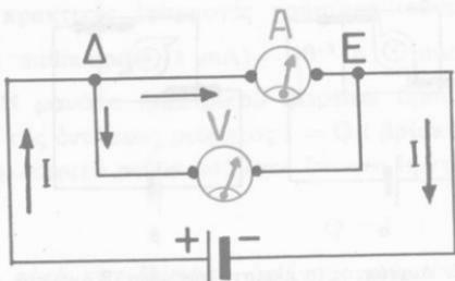
Σχ. 35. Μέτρηση τής έντασεως  $I$  του ρεύματος μέ τό άμπερόμετρο (Α) και τής τάσεως  $U$  μεταξύ τῶν σημείων  $\Delta$  καὶ  $E$  μέ τό βολτόμετρο (V).
