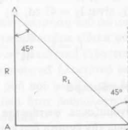
Σχ. 170. Υπολογισμός του φωτισμού στά σημεία A και Γ του έδαφους.
