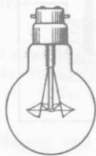
Σχ. 40. Ήλεκτρικός λαμπτήρας πυρακτώσεως.
