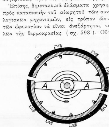
Σχ. 593. Ἡμιδακτύλιοι ἐκ διμεταλλικοῦ ελάσματος διὰ τὴν τήρησιν σταθερᾶς πορείας εἰς ὥρολογια.
