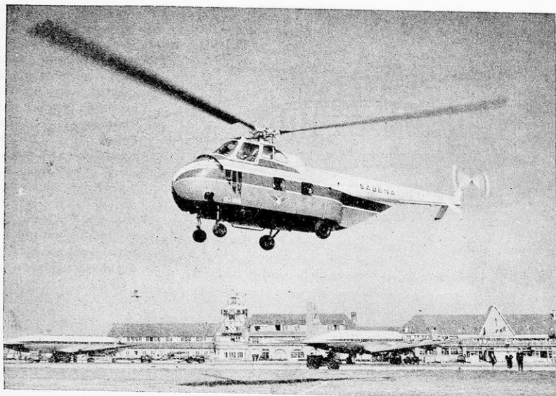
Σχ. 528. 'Ελικόπτερον της Βελγικής 'Εταιρίας Sabena, 12 θέσεων. 'Αναπτύσσει ταχύτητα 170 km/h. 'Ανέρχεται μέχρις ύψους 500 m.
