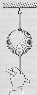
Σχ. 43. Ἡ σφαῖρα ἔχει μᾶζαν 10 kgf περίπου. Ἐὰν σύρωμεν ἡπίως, θραύεται τὸ ἄνω σχοινίον, ἐὰν δὲ σύρωμεν ἀποτόμως θραύεται τὸ κάτω.
