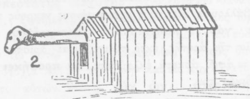
2. Κριός προκεκαλυμμένος ἐντὸς χελώνης (χελώνη κρισφόρος). Καὶ τὰ δύο εἶδη τοῦ κριοῦ ἐχρησιμοποιοῦντο πρὸς κατακρήμνισιν τειχῶν.
