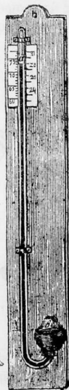
διμως εἶνε ἔνωμένη μὲ τὸν κύλινδρο καὶ κλεισμένη μὲ ἓνα δέρμα. Ἀπὸ τοὺς πόρους ποὺ ἔχει τὸ δέρμα, μπαίνει ἀέρας στὴ λεκάνη καὶ πιέζει τὸν ύδραργυρο. Δίπλα στὸν σωλῆνα εἶνε μιὰ κλίμακα γιὰ νὰ βλέπωμε τὸ ὑψος τῆς στήλης τοῦ ὑδραργυροῦ.
