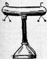
Σχ. 58. Ἐπάνω στὸν κύλινδρο μένει μόνον τὸ ἓνα εἶδος τοῦ ἠλεκτρισμοῦ.
