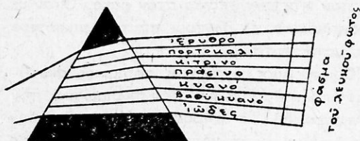
Σχ. 42. Τὸ πρίσμα ἀναλύει τὸ λευκὸ φῶς σὲ ἀπλὰ χρώματα.
