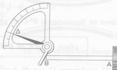
Σχ. 170. Γιά τὴ μέτρηση τῆς γραμμικῆς διαστολῆς τῶν στερεῶν
