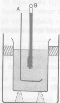
Σχ. 176. Θερμιδόμετρο μέ νερό (Θ θερμόμετρο, Α δργανο γιά τό άνακτεμα)
