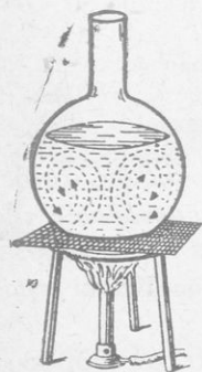
Σχ.33.—Ἡ θερμότης εἰς τὰ ὑγρά μεταδίδεται διὰ ρευμάτων.
