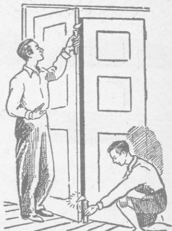
Σχ. 34.—Ἡ διεύθυνσις τῆς φλόγας τῶν κηρίων δείχνει, πῶς γίνεται ἡ κυκλοφορία τοῦ ἀέρος εἰς μίαν αἴθουσαν.
