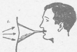
Σχ. 119.—Ἡ ἀτμοσφαιρικὴ πίεσις ἐνεργεῖ πρὸς ὄλας τὰς διευθύνσεις.
