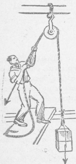
Σχ. 82. — Μετὴν παγίαν τροχαλίαν ἀνυψώνομεν εὐκολώτερον βάρη σῶματα.
