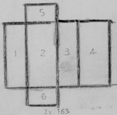
**160. Κατασκευὴ ὄρθογωνίου παραλληλεπιπέδου.**— Κατασκευάζομεν ἐκ χαρτονίου τὸ σχῆμα 163, τὸ ὅποιον ἀποτελεῖται ἀπὸ ἑξ ὄρθογώνια, ἐκ τῶν ὅποιών τὰ 1 καὶ 3 εἶναι ἵσα μεταξύ των. Ἐπίσης ἵσα μετοξύ τῶν εἶναι τὰ 2 καὶ 4, ὡς καὶ τὰ 5 καὶ
