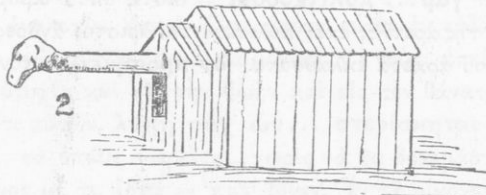
2. Κριός προκεκαλυμμένος ἐντὸς χελώνης (χελώνη κριοφόρος). Καὶ τὰ δύο εἶδη τοῦ κριοῦ ἐχρησιμοποιοῦντο πρὸς κατακρήμνισιν τειχῶν.
