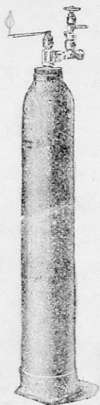
Εικ. 198. Χαλυβδίνη όβλις περιέχουσα άέριον υπό πίεσιν.
