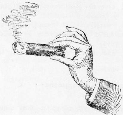
Εἰκ. 2. Δυνάμεθα νὰ κρατῶμεν ἐν κάρβουνον ἀναμμένον εἰς τὸ ἄλλο ἄκρον, χωρὶς νὰ αἰσθανώμεθα θερμότητα.
