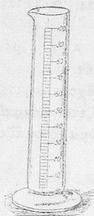
Εἰκ. 39. Δοχεῖον με διαιρέσεις, αἱ ὅποια δεικνύουν τὰ κυθικά ἑκατοστόμετρα.
