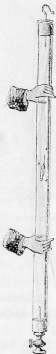
Εἰκ. 61. Τὰ σώματα εἰς τὸ κενὸν χρειάζονται τὸν αὐτὸν χρόνον διὰ νὰ διανύσουν τὸ αὐτὸ διάστημα.
