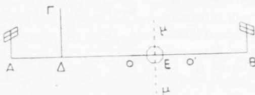
δογικῶν μετακινήσεων τοποθετοῦμεν τὸ δργάνον ἐπὶ σημείου τινὸς τῆς εὐθείας  $AB$  ὅπότε τὸ σκοπευ-
