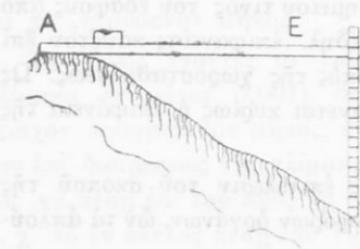
ρίσωμεν τὴν ὑφομετρικὴν διαφοράν. Πρὸς τοῦτο ἐπὶ τοῦ σημείου Β ὑφοῦμεν κανόνα Δ διηρημένον εἰς μέτρα καὶ ὑποδιαιρέσεις αὐτοῦ, ἐπὶ δὲ τοῦ Α θέτομεν τὸ ἄκρον ἐτέρου κανόνος Ε, τὸν δοιον διευθύνομεν κατὰ τὴν διεύθυνσιν ΑΒ δριζόντιως· ἐπιτυγχάνεται δὲ τοῦτο διὰ τοῦ ἀλφαδίου ἢ τῆς
