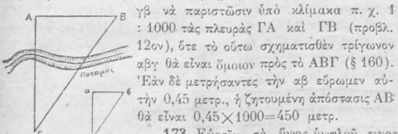
γβ νὰ παριστῶσιν ὑπὸ κλίμακα π. χ. 1 : 1000 τὰς πλευρὰς ΓΑ καὶ ΓΒ (προβλ. 12ον), ὅτε τὸ οὕτω σχηματισθὲν τρίγωνον αβγ θὰ εἴναι ὅμοιον πρὸς τὸ ΑΒΓ (§ 160). Ἐὰν δὲ μετρήσαντες τὴν αβ εύρωμεν αὐτὴν 0,45 μετρ., ἡ ζητουμένη ἀπόστασις ΑΒ θὰ εἴναι  $0,45 \times 1000 = 450$  μετρ.
