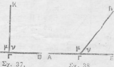
Δύο εὐθεῖαι καλοῦνται κάθετοι πρὸς ἀλλήλας, ἐὰν συναντώμεναι σχηματίζωσι τὰς δύο ἐφεξῆς γωνίας ἵσας καὶ πλάγιαι ἐὰν σχηματίζωσι τὰς δύο ἐφεξῆς γωνίας ἀνίσους.
