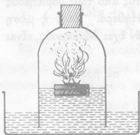
Σχ. 37. Παρασκευή ἀτμοσφαιρικοῦ ἀζώτου γιά κάυση φωσφόρου.
