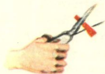
Εικ. 37. Παράδειγμα μοχλού 1ου είδους.
