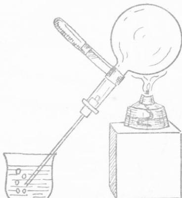
Σχ. 5. Διαστολὴ τῶν ἀεοίων. Ὁ ἀὴρ τῆς φιάλης θερμαίνομενος διαστέλλεται καὶ ἔξερχονται φυσαλίδες.
