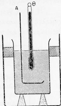
Σχ. 244. Θερμιδόμετρον. (Α ἀναδευτήρ, Θ θερμιόμετρον).
