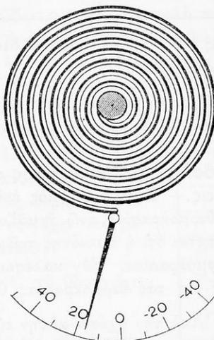
Σχ. 239. Διμεταλλικὸν θερμομετρὸν.
