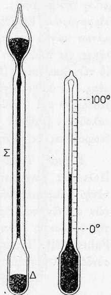
Σχ. 234. Κατασκευὴ ὑδραργυρικοῦ θερμομέτρου.
