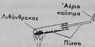
Σχ. 20. Ξηρή απόσταξη του λιθάνθρακα. Σχηματίζονται πίσσα και άερια καύσιμα.
