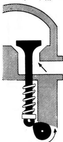
Σχ. 266. Μηχανισμὸς αὐτομάτου λειτουργίας τῶν βαλβίδων
