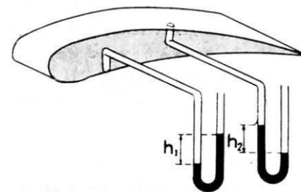
Σχ. 180. Μέτρησης τής διαφοράς πίεσεως
