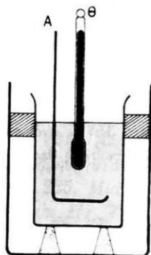
Σχ. 243. Θερμιδομέτρον (A ἀναδευτήρ, Θ θερμόμετρον)
